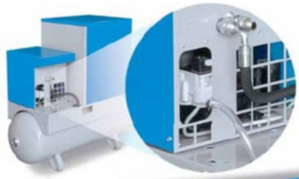
MSM maxi med tank og kjøletørker. Leveres standard med integrert ECD kondensatavleder (elektronisk nivåstyrt). Opsjon med filterkominasjon og by-pass for teknisk oliefri trykkluft. ISO 8573:1 Klasse 1 – 4 – 1 (99,99% renhet).
